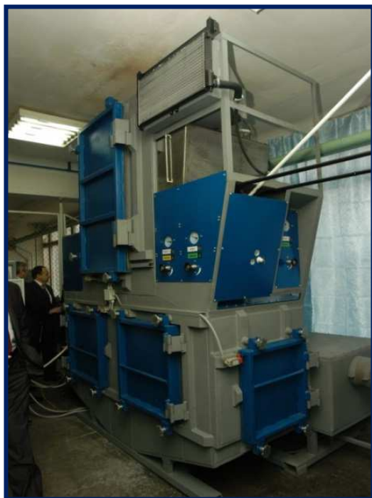
Рис. 5. Детонационная установка для напыления функционально-ориентированных покрытий
